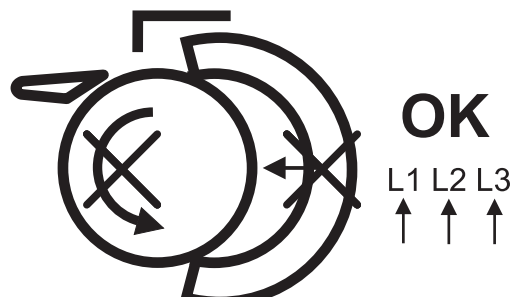
(B) Richtige Phasenfolge und Wanne geöffnet.
