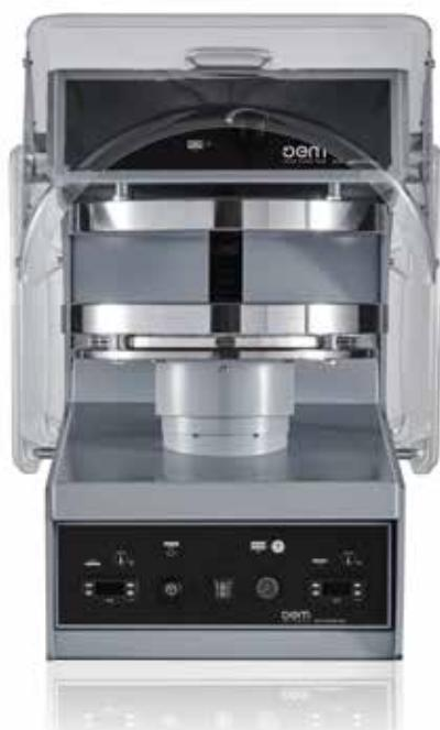
Ancora più evoluta e performante, la serie Pressform MTE utilizza una vite a ricircolo di sfere per un'azione fluida e potente e piatti di maggiore spessore che offrono un migliore mantenimento termico. Vanta una grande robustezza perché ha superato addirittura 1.100.000 cicli di prova. Un vero record!
